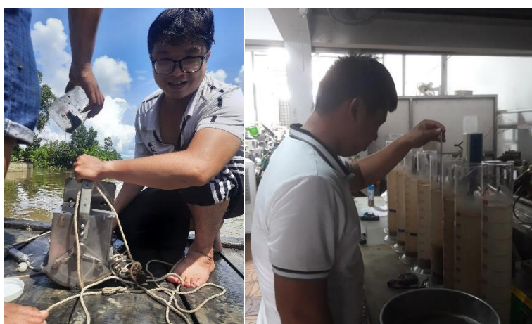
Hình 7. Thu mẫu bùn đáy và làm thí nghiệm thành phần hạt.
